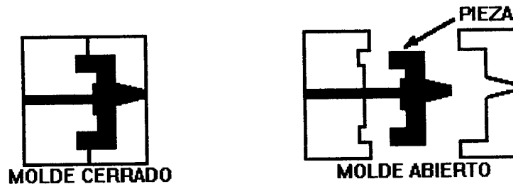
Figura 8. Enfriamiento y extracción de la pieza
