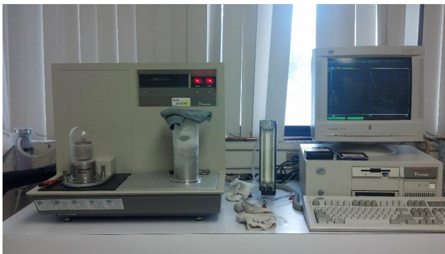
Figura 22. Equipo de DSC empleado para la determinación de las transiciones térmicas del PB.
