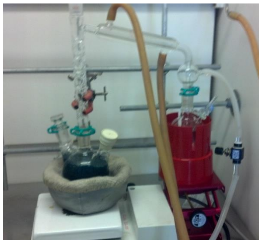
Figura 34. Destilación de estireno en atmósfera de nitrógeno, empleando sodio metálico para eliminar impurezas.
