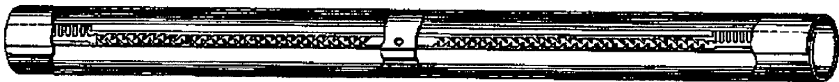
Fig. 39. Cinta de riego por goteo con dos entradas y dos canales reductores de presión por cada salida. DeFrank et al., 1998.
