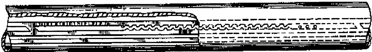
Fig. 66. Cinta de riego por goteo con una cámara para almacenar un químico protector del material plástico. DeFrank, 1994.
