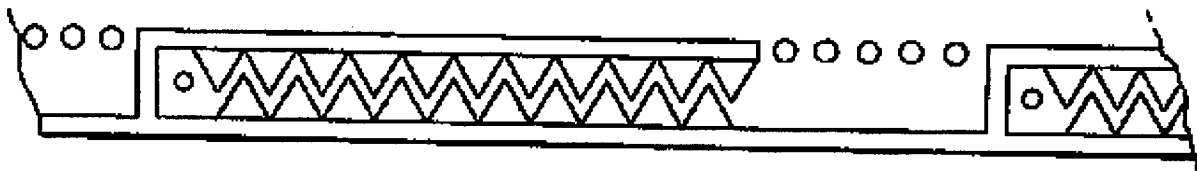
Fig. 49. Canal regulador de flujo con compensación de presión. DeFrank, 1994.
