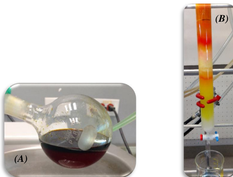
Figura 19 (a) Precursor del agente CTPPA: Bis (propilsulfaniltiocarbonil) disulfuro. (b) Columna de sílica para purificación del agente CTPPA
