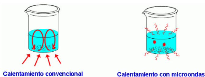
Figura 19. Transferencia del calor desde las paredes al interior del recipiente.
