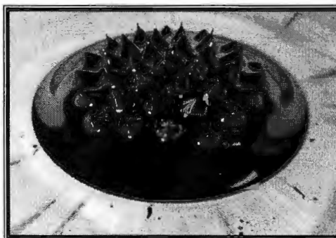
Figura 2.13 Ferrofluido bajo la influencia de un campo magnético
