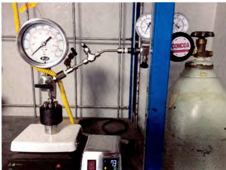
Figura 15. Reactor de acero inoxidable de Paar Instrument Company© conectado a tanque de CO 2 .
