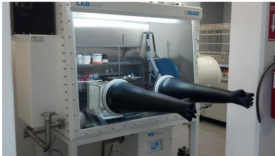
Figura 14. Caja de guantes utilizada para preparar el catalizador.
