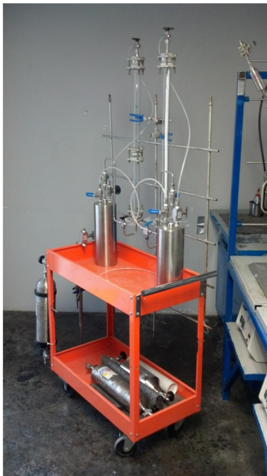
Figura 12. Suministrador móvil de disolventes.
