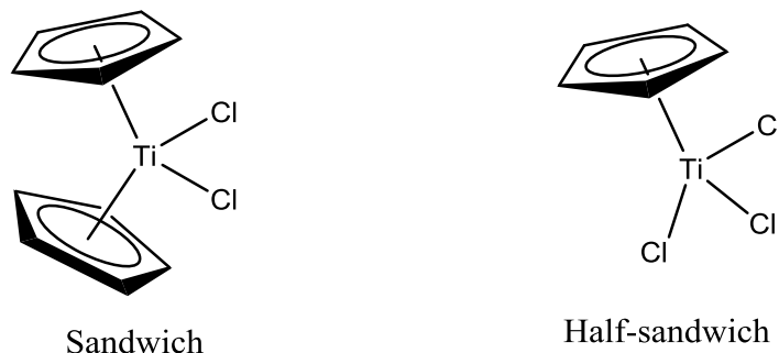
Figura 5. Arreglos de los catalizadores titanocenos, diciclopentadienil-dicloro-titanio (Sandwich) y ciclopentadienil-tricloro-titanio (Half-sandwich).
