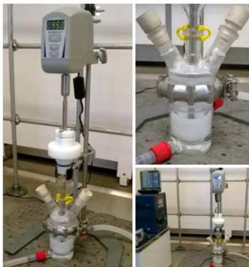
Figura 4.1. Sistema de reacción en el cual se prepararon las nanopartículas de PECA.
