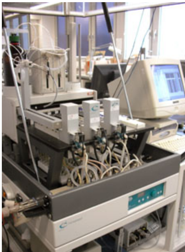
Figura 8. Equipo de química combinatoria utilizado en la síntesis de los polímeros vía masa a 500 rpm y 130°C.
