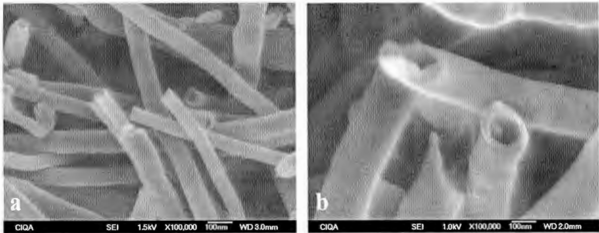
Figura 6.5. Micrografías FE SEM de CNFs con tratamiento con \text{HNO}_3 al 70%, 30 min y a) 300 W y b) 1200 W.
