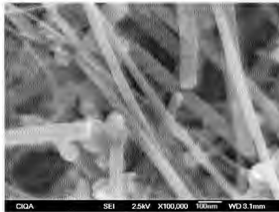
Figura 6.7. Micrografía de FE SEM de nanofibras modificadas con \text{HNO}_3 al 70% vol., 300 W y 5 min.
