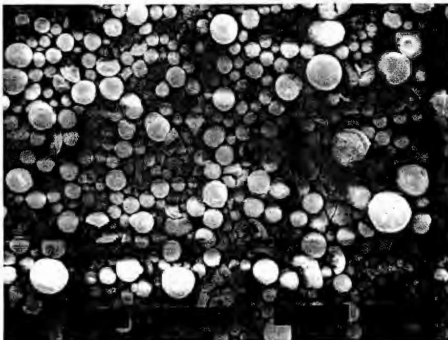
***Figura B-2.- Micrografías por SEM de la sílica PQ***
