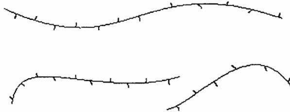
**Figura 13.- Estructura del Polietileno Lineal de Baja Densidad (LLDPE) [26,27]**
