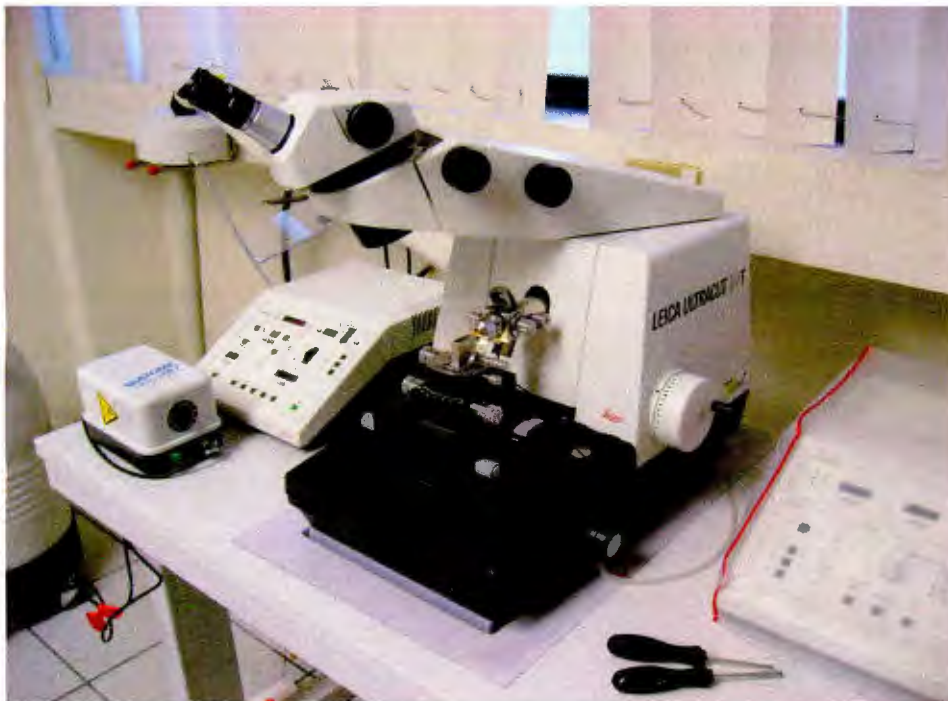
Figura 3.5 Equipo ultramicrotomo marca LEICA utilizado para hacer cortes nanométricos a la muestra de nanocompuesto formulado.
